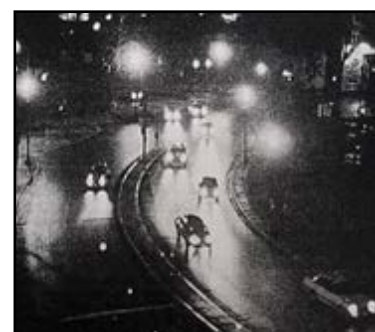
تصویر ۳- سطوح مرطوب جاده، وقتی نورهای خیابان و ترافیک را منعکس می کند، باعث ایجاد خیرگی چشم می شود. خیرگی چشم در جاده ها به علت حرکت مداوم اتومبیلها با چراغهای روشن تشدید می شود. این امر به علت خدشه ای آنی که در قدرت دید ایجاد می کند بالقوه خطرناک است و می تواند رانندگی در شب را مشکل سازد، (منبع: An IESNA، 1999: 2).
