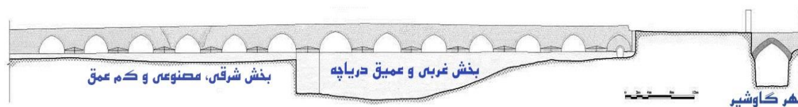
تصویر ۱۲- برش عرضی رودخانه و نمای پل بند امیر در بالادست (نمای شمالی). منبع: (نگارنده)
